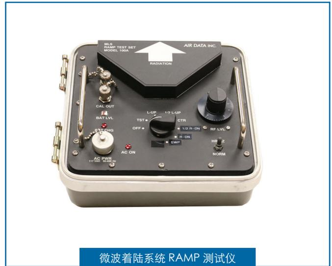
微波着陆系统 RAMP 测试仪
